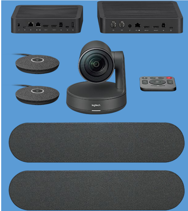
Exempel på Logitech Rally med kopplingsenheter, bordsmikrofoner, kamera, fjärrkontroll samt ekosläckande högtalare
