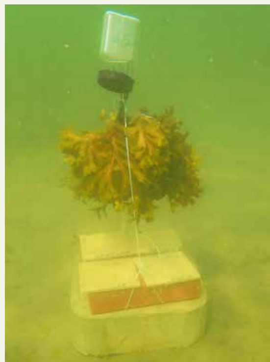
Figur 3.17. Tångbuketten fästs med ett flöte ovanför stenen. Avståndet anpassas så att tångbuketten inte vidrör stenen. Bilden visar en experimentenhet placerad ovanpå ett cementblock på sandbotten för att testa metoden. Använd korkflöten och inte en plastflaska som på bilden, då den ändrar sin flytkraft med vattentemperaturen.
