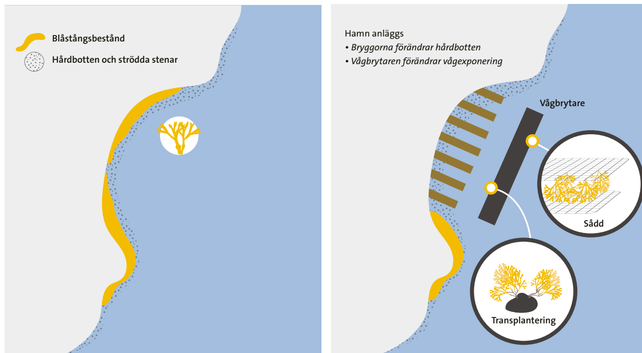
Figur 2.5. Vid anläggning av en småbåtshamn kommer blåstångsbeståndet utmed stranden att minska. En kompensationsåtgärd genomförs genom att etablera blåstång genom sådd och transplantera tång på stenar till den nya vågbrytaren.
