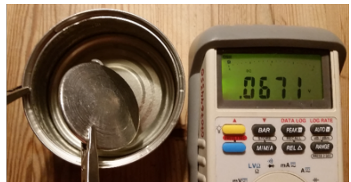
Bild b: Konservburk och Sn(s) ger 0.07 V potentialskillnad (Foto: Lars Eriksson).
