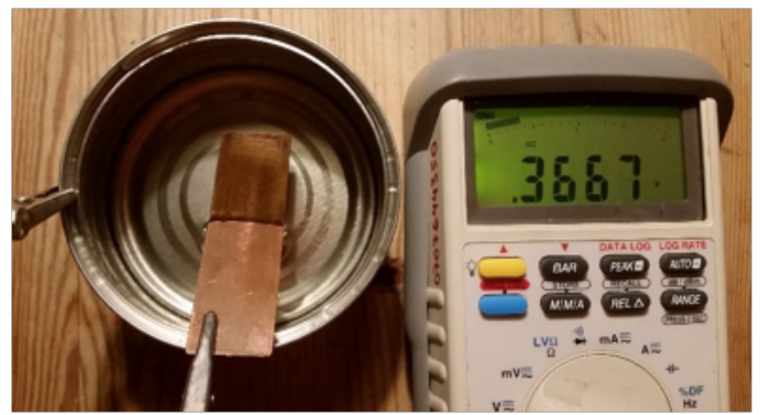
Bild a: Konservburk och Cu(s) ger 0.37 V potentialskillnad (Foto: Lars Eriksson)
