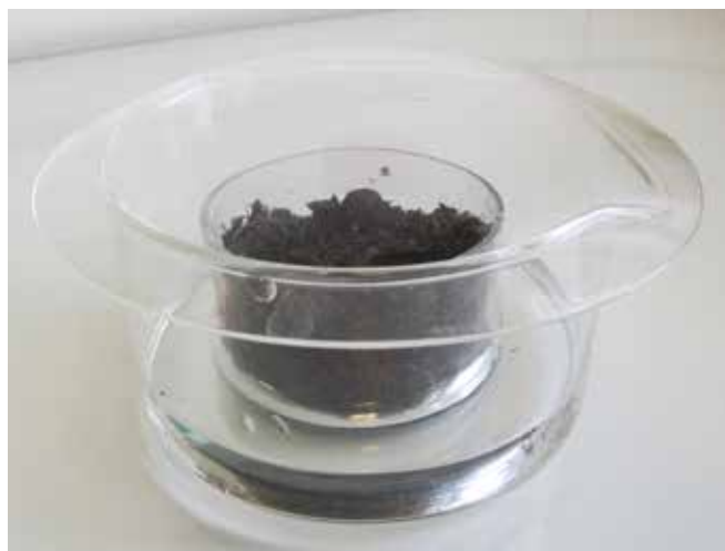
Försökupställning: Bägare med jord i kristallisations-skål med kalkvatten och med urglas ovanpå. ANVÄND PLASTFOLIE SOM LOCK
