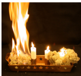
Bild 1: Obehandlad (till vänster) och behandlad fönsterlav (till höger). (Foton: KRC)
