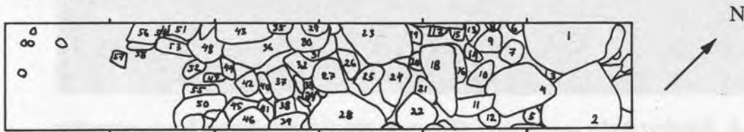
Fig. 8. Avvägningsplan, överförd från lodfotoplanen, över det framrensade övre stenskiktet. Samtliga avvägningsbara stenar (58 st) har numrerats. Översättningstabell nedan med värden som anger höjden över Mälarens yta. Skala 1:50.
