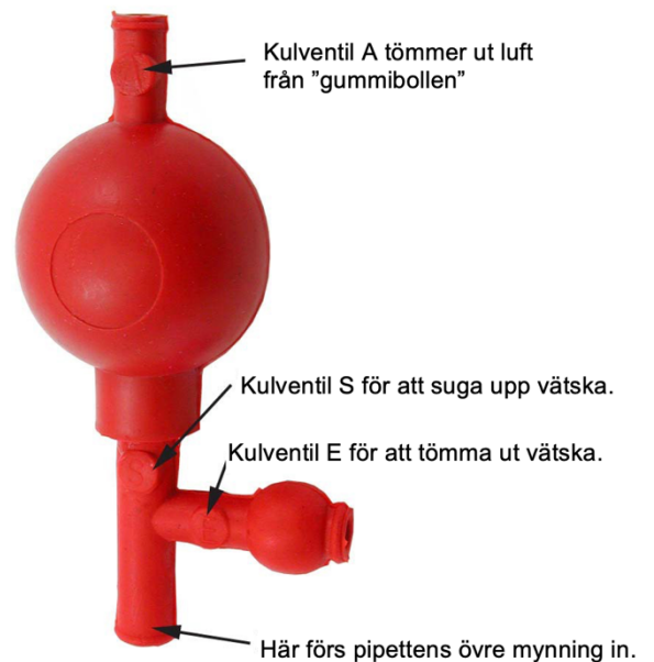
Bild 1: En pipettfyllare (peleusboll) med beskrivning av ventilernas funktion.
