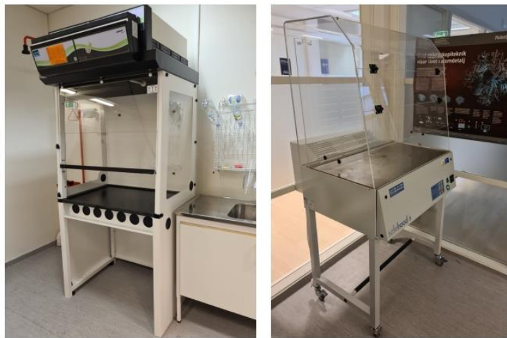
Bild 1: Stationärt dragskåp från CiAB (Foto: Christian Killiner) Bild 2: Flyttbart dragskåp från LabRum (Foto: Christian Killiner)
